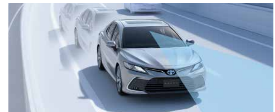
HỆ THỐNG ĐIỀU KHIỂN HÀNH TRÌNH CHỦ ĐỘNG (DRCC) Là công nghệ an toàn chủ động sử dụng radar gắn dưới lưới tản nhiệt phía trước cùng với camera để phát hiện các phương tiện phía trước. Đồng thời tự động điều chỉnh tốc độ để đảm bảo khoảng cách an toàn với các phương tiện đang lưu thông.
